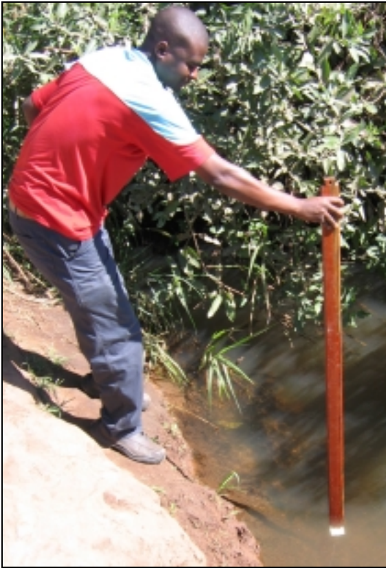
Figura 2 – A turbidez das águas foi avaliada verificando a visibilidade dum placa branca de 5 × 5 cm fixada numa regra graduada
