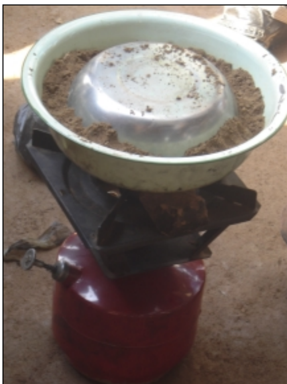
Figura 14 – Usando bacias metálicas por exemplo, a técnica de retorta permite recuperar o mercúrio e reduzir os vapores muito tóxicos quando aquece-se o amálgama
